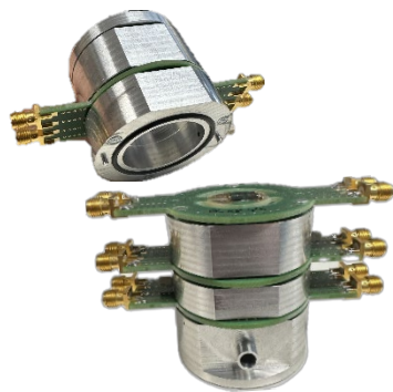
Figure 2 : Impacteur pour la détection des PM10 et PM2.5 développé dans l'équipe COSYMA
